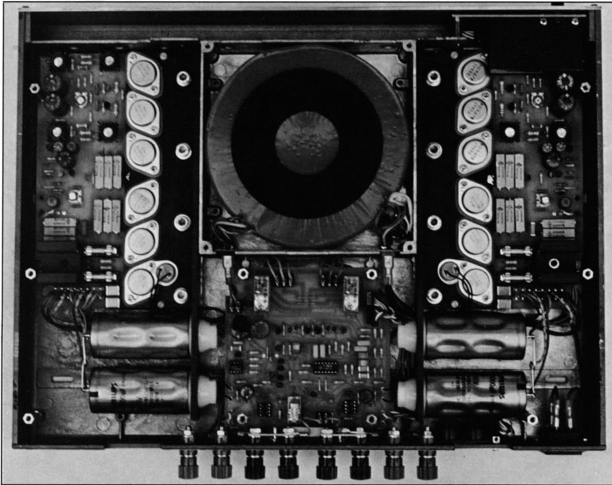
Der Endverstärker E-42. Unten sind die Polklemmen für den Anschluß der Lautsprecherkabel. In der Mitte oben der große Ringkern-Netztransformator. Links und rechts daneben die Endstufentransistoren, deren Wärmeableitung u. a. das Gußchassis übernimmt.
